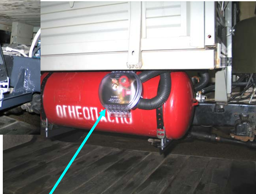
Газовый баллон 50л с вентиляционной камерой и мультиклапаном
