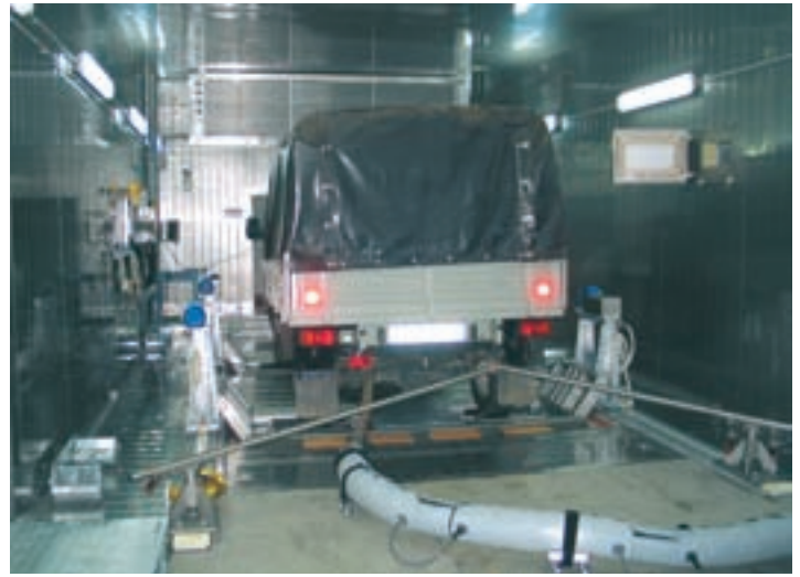
Для достижения соответствия двигателя нормативам Евро-4 УАЗ подвергся всесторонним испытаниям, в том числе в холодильной камере.
