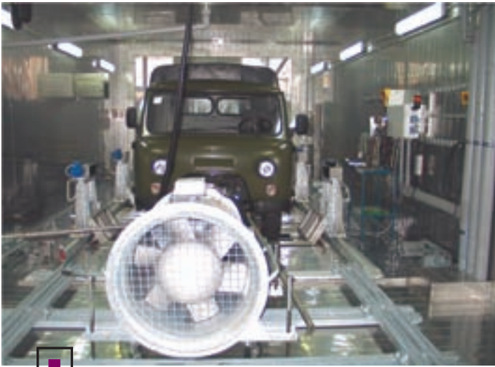
Для достижения соответствия двигателя нормативам Евро-4 УАЗ подвергся всесторонним испытаниям, в том числе в холодильной камере.
