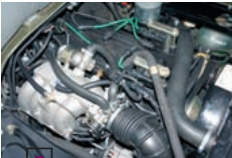
Двигатель ЗМЗ-4091, адаптированный к газу, на первый взгляд не отличается от своего однотопливного собрата.
