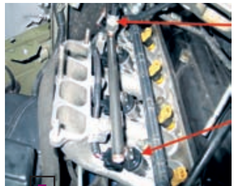
На сборочный конвейер поступает модуль универсальной топливной рамы с газовыми форсунками.
