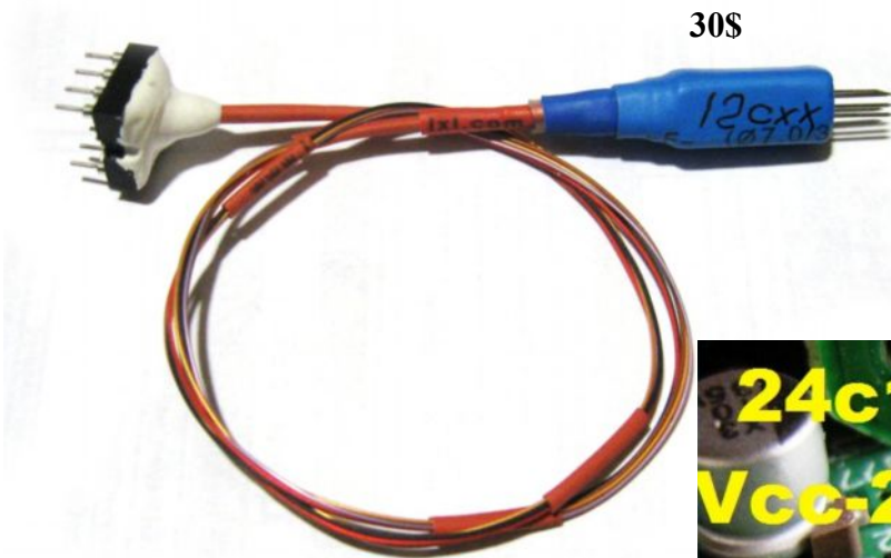
14. Щуп погопиновый SOT 23-5 24сXX, с DIP8 разъемом. Pogo pin test probe SOT 23-5 24сXX, with DIP8 plugs.
