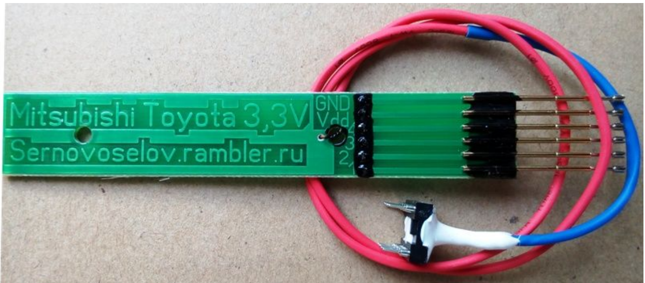
7. Щуп погопиновый MITSUBISHI, TOYOTA, с DIP8 разъемом. Pogo pin test probe Mitsubishi, TOYOTA, with DIP8 plugs. 25$
